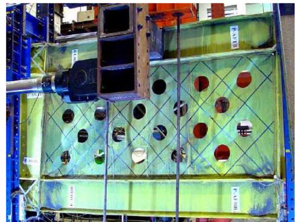
Fig. 8.5. Muro de corte con placas de acero y perforaciones de esquina (Vian y Bruneau, 2004)
