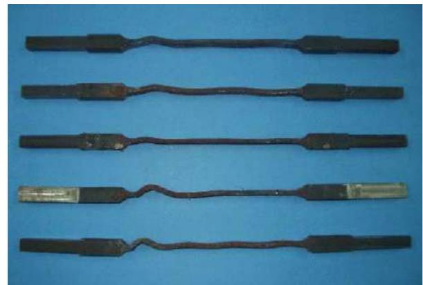
Fig. 7-8. Vista del núcleo de acero de riostras de pandeo restringido ensayadas por Palazzo et al. (2009).
