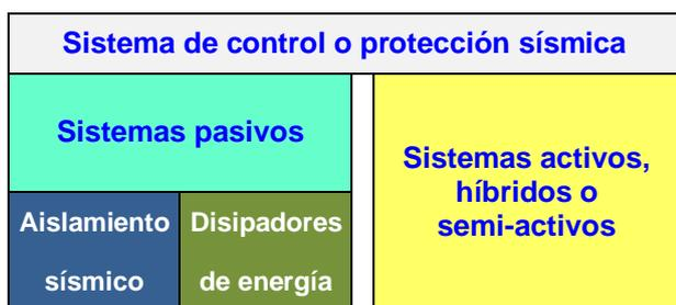
Fig. 2-13. Clasificación de los distintos sistemas de protección sísmica.
