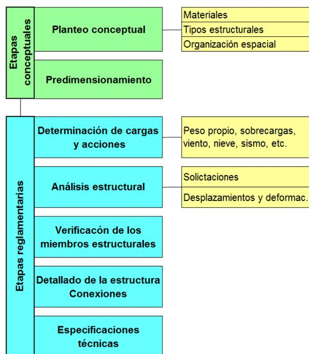
Fig. 10-1. Esquema indicativo del proceso de diseño estructural.
