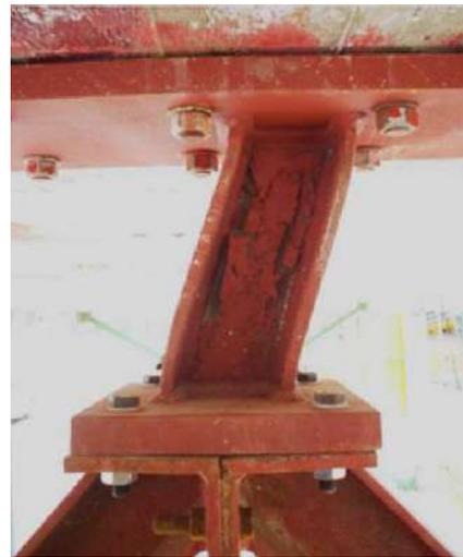
Fig. 6-20. Imagen de un enlace vertical ensayado por [Mazzolani \(2008\)](#).
