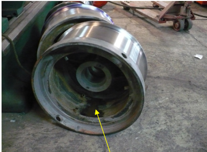
Zona de refrigeración con sarro
