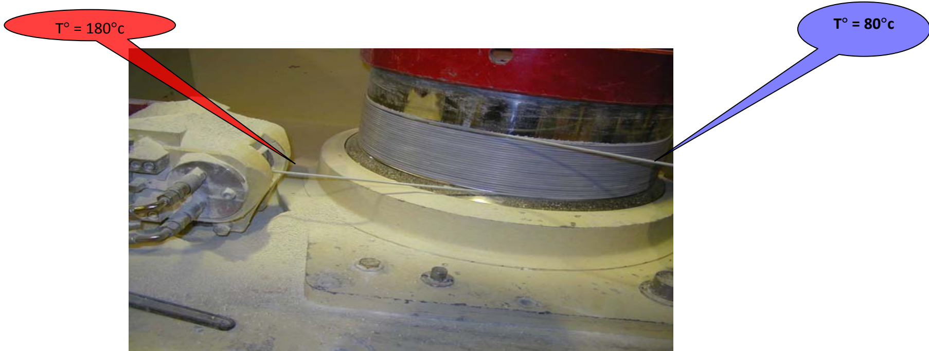
Acumulación en Cabezal para evacuar temperatura del alambre
