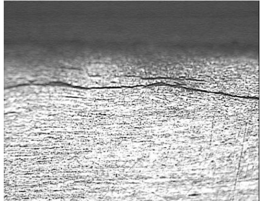
Escamas sin decarburación en alambrión de acero de alto carbono (64X)
